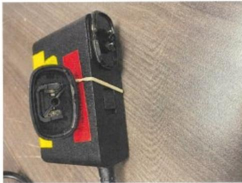
Figure 2 : Prise d'alimentation endommagée
