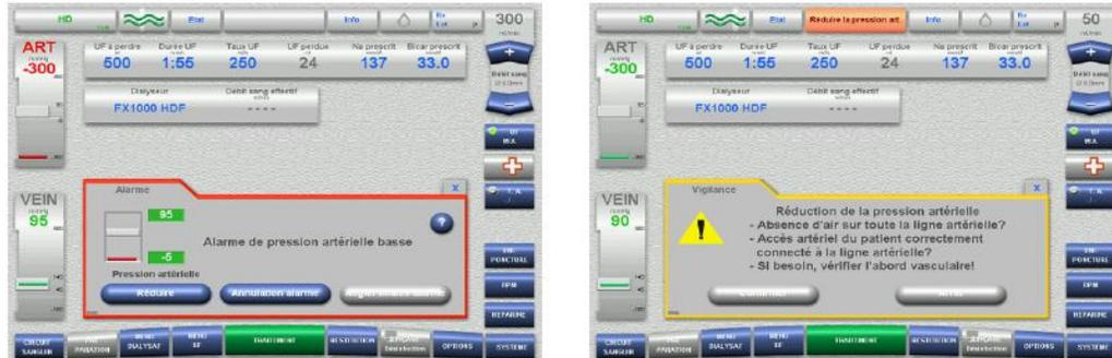
Après avoir administré 15 mL de sang en sens contraire des aiguilles d'une montre, la pompe à sang doit tourner dans le sens des aiguilles d'Une montre avant de recommencer à relâcher la pression
