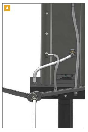
Installer le boyau d'oxygène à l'arrière de l'appareil en utilisant 2 clés ajustables afin de réduire la possibilité de débranchement accidentel du boyau.
