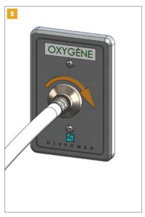
Brancher l'autre extrémité du boyau à la source d'oxygène de 50 l.p.c (p.s.i.) (3 bars).
