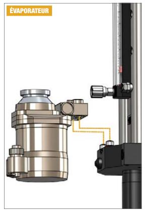
Installez l'évaporateur tel qu'illustré et verrouillez-le à l'aide du mécanisme de l'évaporateur.
