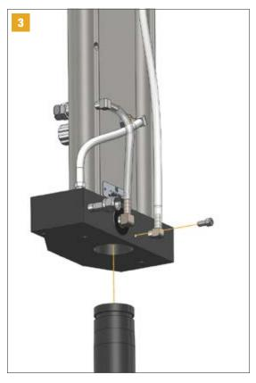
Retirer la tête de l'appareil de la boîte et glisser la sur le dessus du poteau noir (il y a un trou sous le support de la tête). Visser la vis de sécurité à l'arrière de la tête en utilisant la clé fournie.
