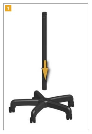
Retirer la base de la boîte et glisser le poteau noir, le côté en forme de cône dans la base.
