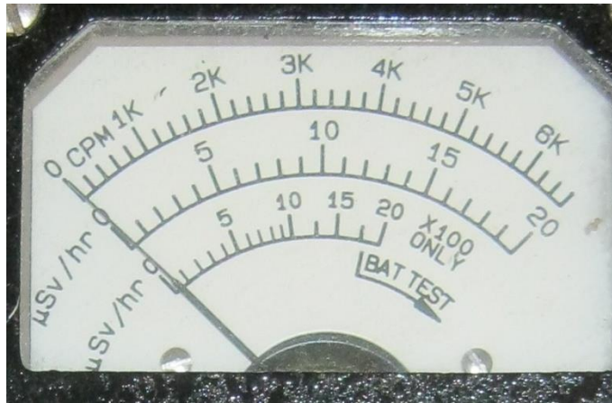
Figure 6 –Échelle de lecture d'un compteur G-M permettant une mesure de contamination (cpm) et une mesure de débit de dose ( \mu\text{Sv}/\text{hr} ).
