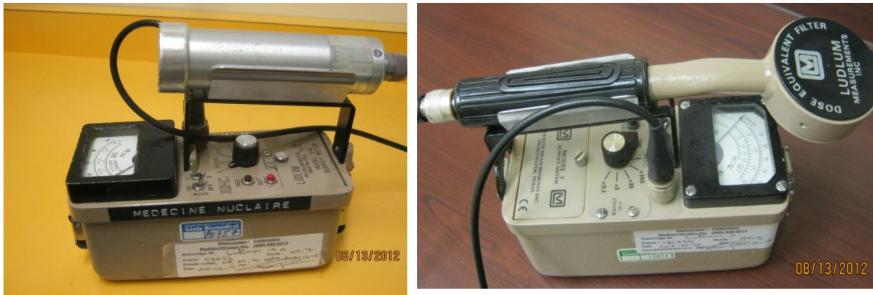
Figure 5 – Contaminamètres de type compteur G-M (modèle Ludlum) avec sonde en bout (gauche) et sonde « pancake » (droite).
