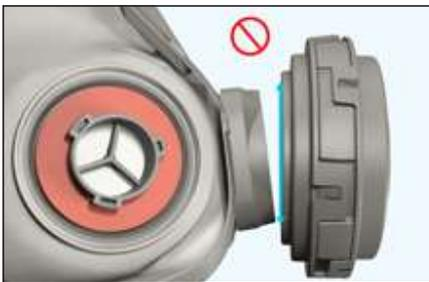
4. Si le filtre de soupape d'exhalation n'est pas positionné uniformément sur le couvercle de soupape, comme illustré ci-dessus dans la Fig. 4, répétez les étapes 2 et 3.
