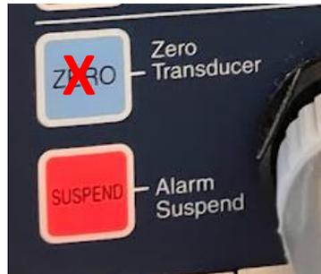
**Attention → Ne Jamais Appuyer sur Zero Transducer lorsque ICP est branché sur un usager**
