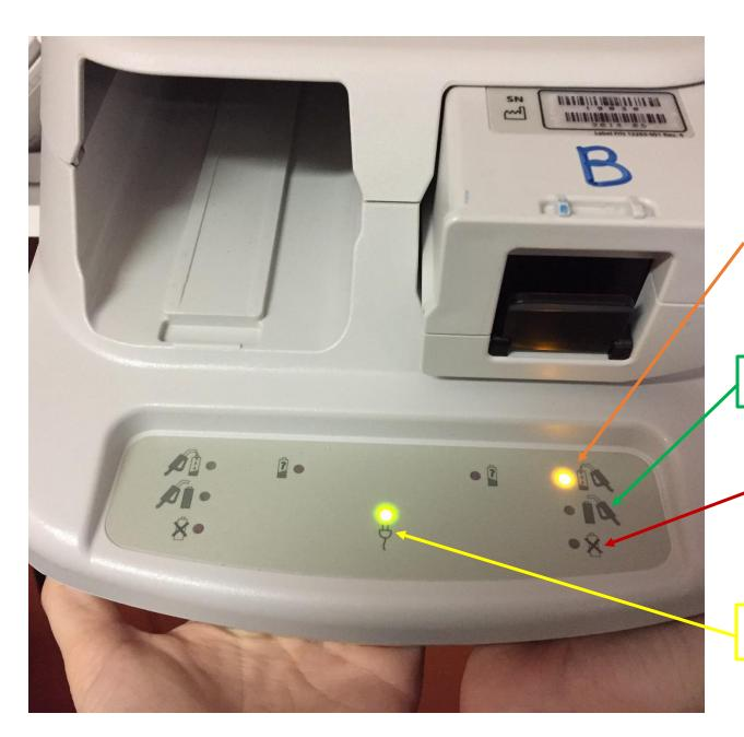
Indique que la batterie est bien en charge. S'assurer que ce témoin lumineux soit allumé quand vous installer la batterie sur le chargeur.
